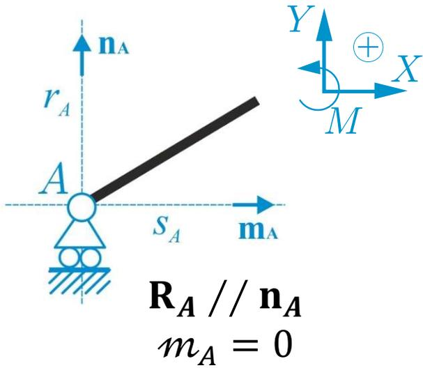
Può erogare in  $A$  una forza di modulo e verso qualsiasi, ma parallela all'asse  $r_A$
