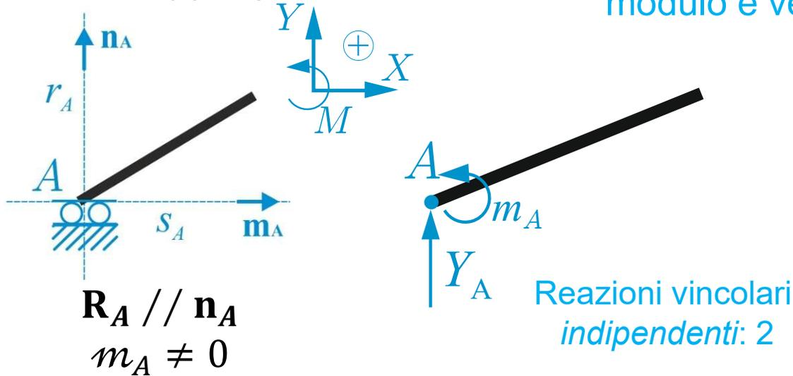
Può erogare in  $A$  una coppia e una forza di modulo e verso qualsiasi, ma parallela all'asse  $r_A$
